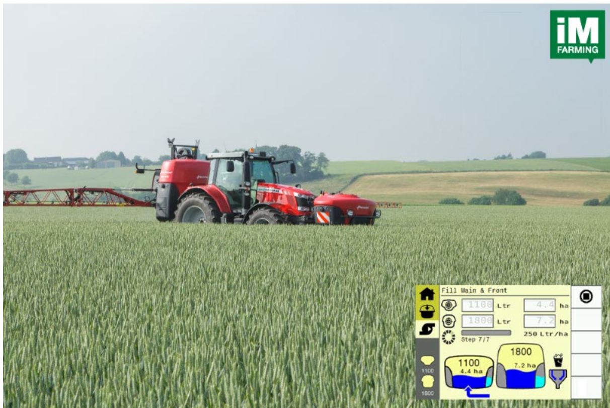
TwinFill er et kombineret påfyldningsprogram til den for- og bagmonterede sprøjtetank
