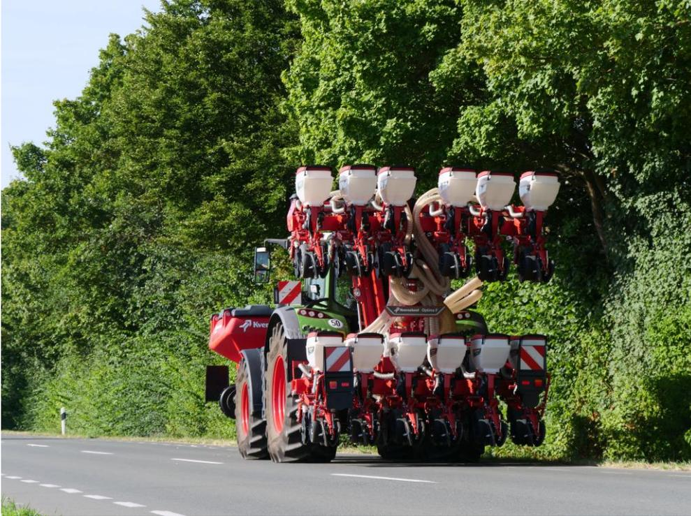
Image : Repliage rapide en position de transport : Optima F avec 12 rangs SX
