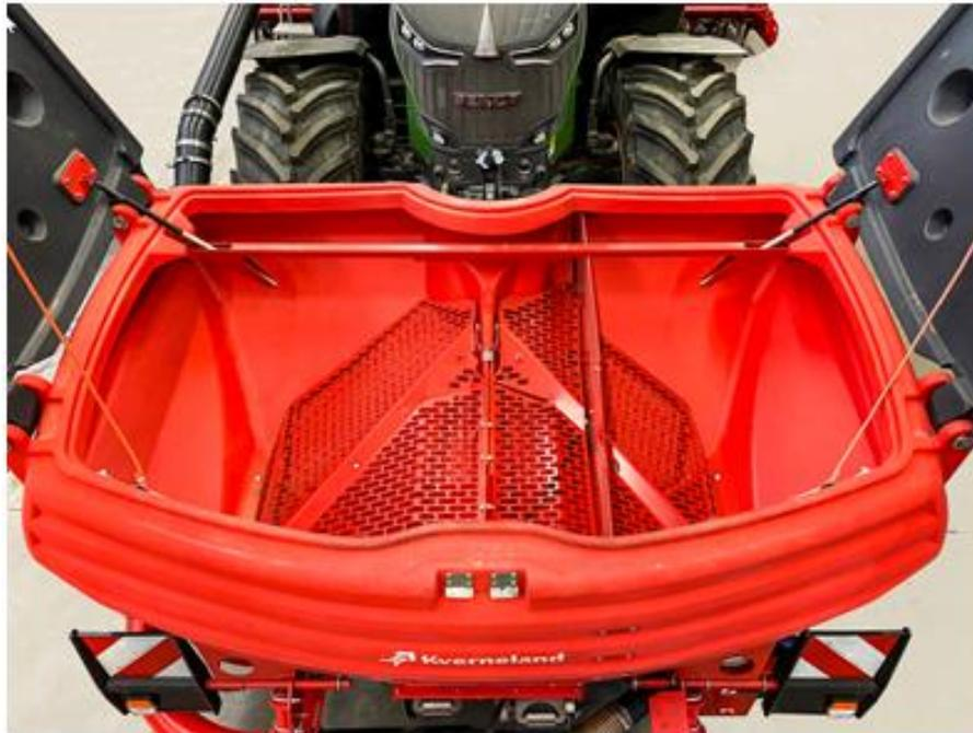
Image : Trémie frontale f-drill maxi plus compartimentée 60:40
