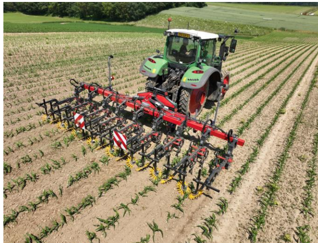
Kverneland Reihenhacke Onyx mit Verschieberahmen Lynx
