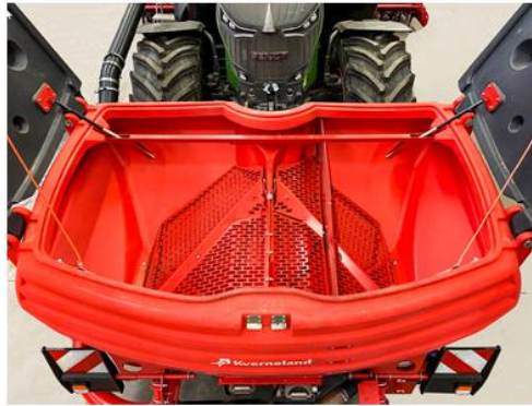
Kverneland f-drill maxi plus Tankteilung im Verhältnis 60:40
