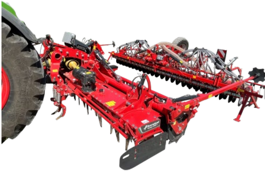
Barre de semis Kverneland f-drill CB F avec connexion rapide CAT. II
