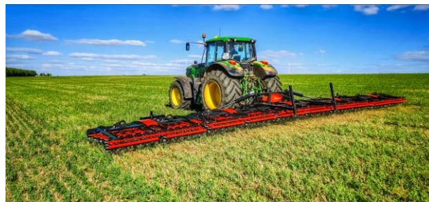
Kverneland Arcadia Striegel mit 12 m Arbeitsbreite
