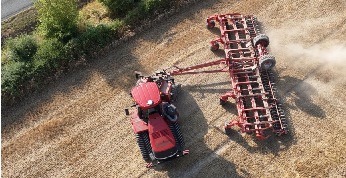
Kverneland Qualidisc T vending på forager foregår med dybdehjul og pakkervalse.
