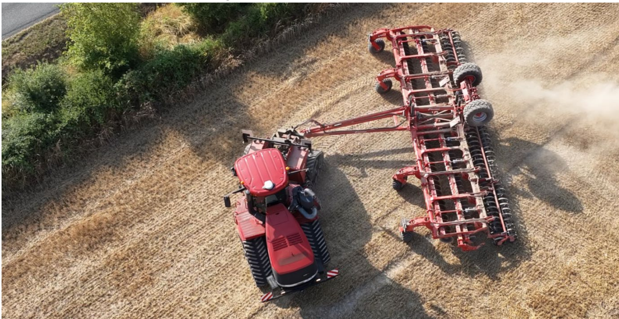
Kverneland Qualidisc T gira a fine campo su ruote sagomate e rullo posteriore
