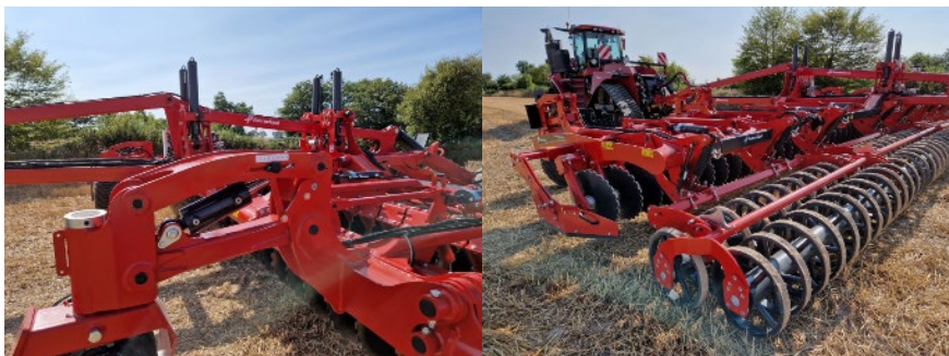
Kverneland Qualidisc 21123 T preimpostazione della profondità nella parte anteriore e posteriore della macchina
