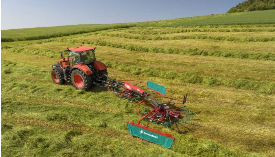
Image : Déport latéral SideShift du rotor
