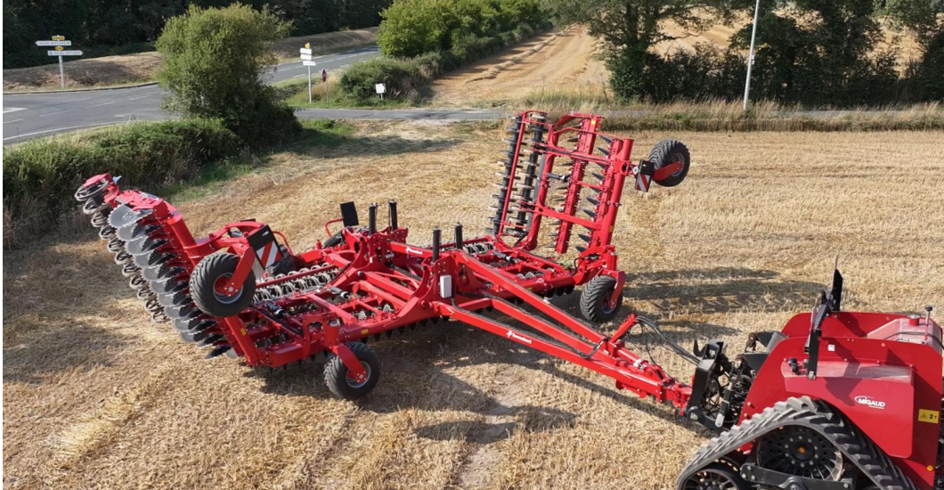
Image : Kverneland Qualidisc T se replie avec un système en porte feuille
