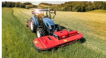
Vicon EXTRA 332 XF Compact avec une largeur de travail de 3,2 m et le concept de vis XF.
