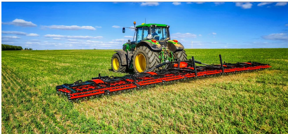
Brona zębowa Kverneland Arcadia o szerokości roboczej 12 m
