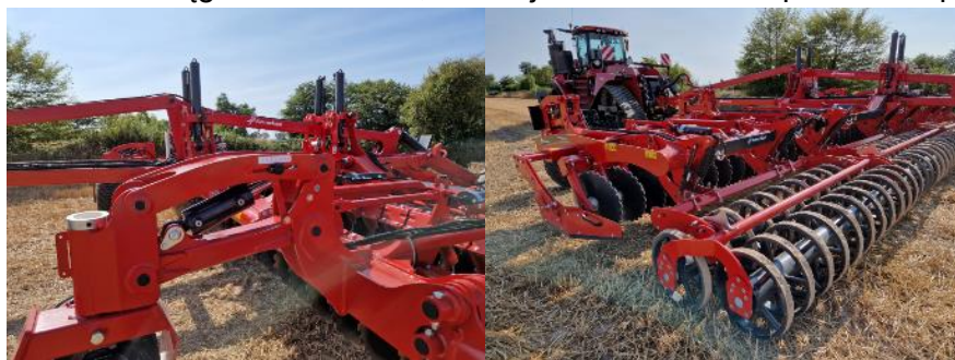
Kverneland Qualidisc 21123 T wstępne ustawienie głębokości z przodu i z tyłu maszyny
