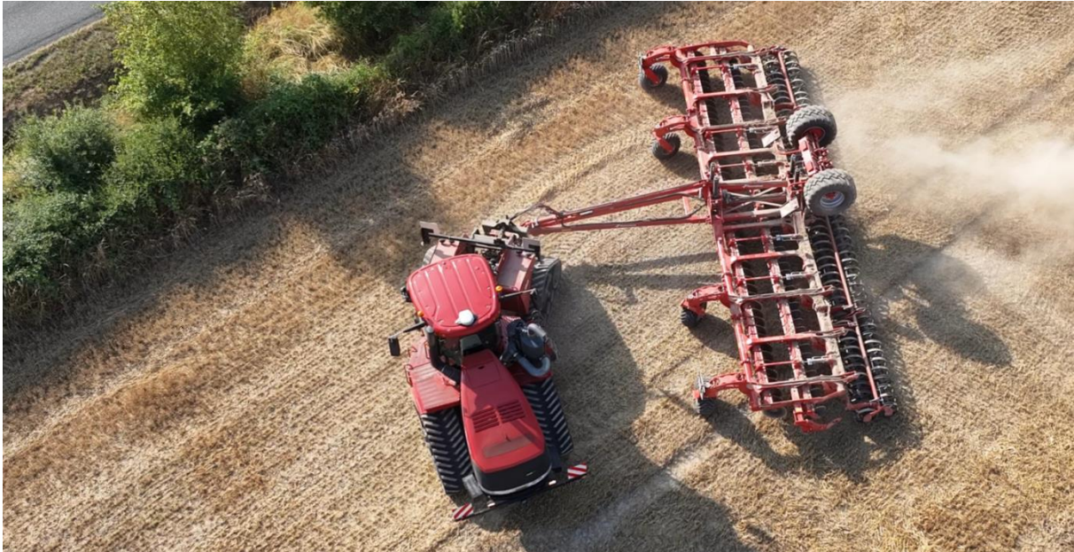
Kverneland Qualidisc T skręt na uwrociu na kołach kopiujących i tylnym wale
