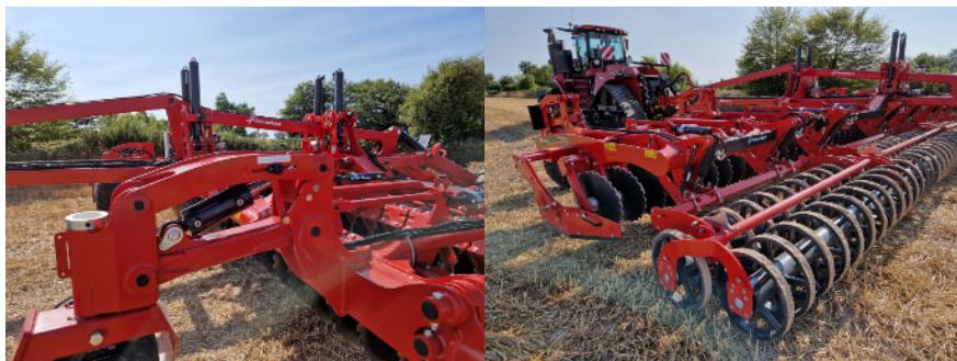
Kverneland Qualidisc 21123 T előzetes mélységállítása a gép elején és hátulján
