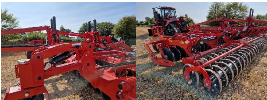
Kverneland Qualidisc 21123 T voorinstelling van de diepte aan de voor- en achterkant van de machine
