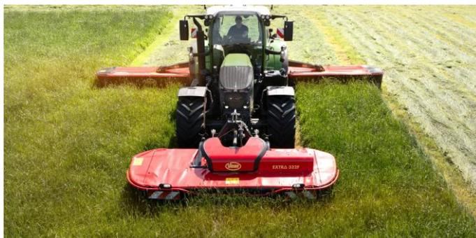
*Das neue Vicon 300F Frontmäherwerk überzeugt mit kompakter Bauweise, gesteigertem Bedienkomfort und überragender Konturfolge*
