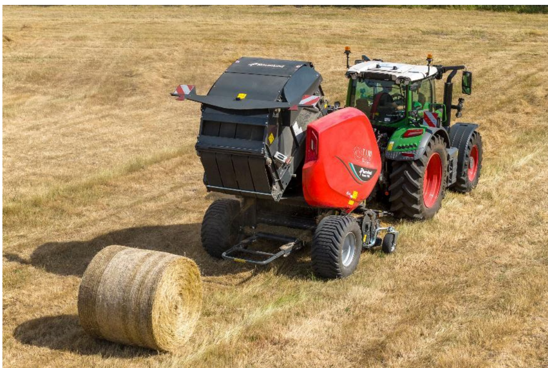
Kverneland Densus navržený pro vysoce kvalitní balíky až do délky 1,85 m
