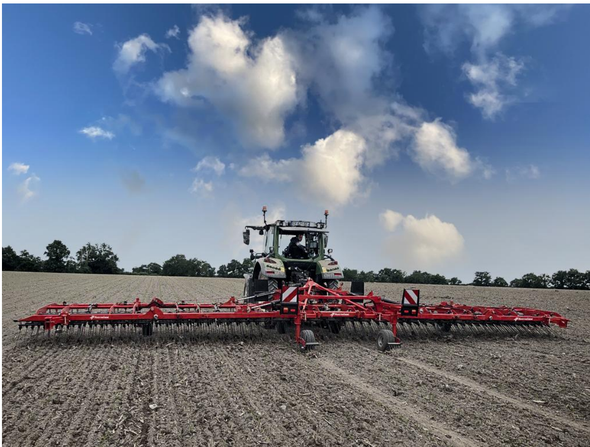
Kverneland Arcadia prutové brány pro odstranění plevelu s pracovní šířkou 12,2 m
