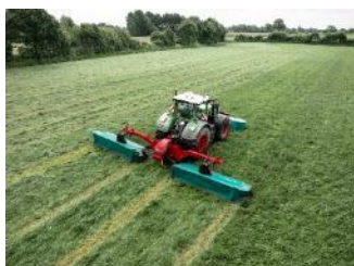
Kverneland 5395 jednoduchá trojitá žací lišta s pracovní šířkou 9,5 m
