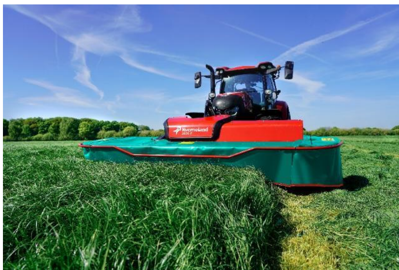
Nová přední žací lišta Kverneland 2832 F s kompaktním designem a vysoce citlivým odpružením
