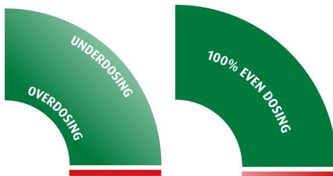
iXflow-Pulse z iXcurve – jednakowa dawka oprysku w każdym segmencie belki
