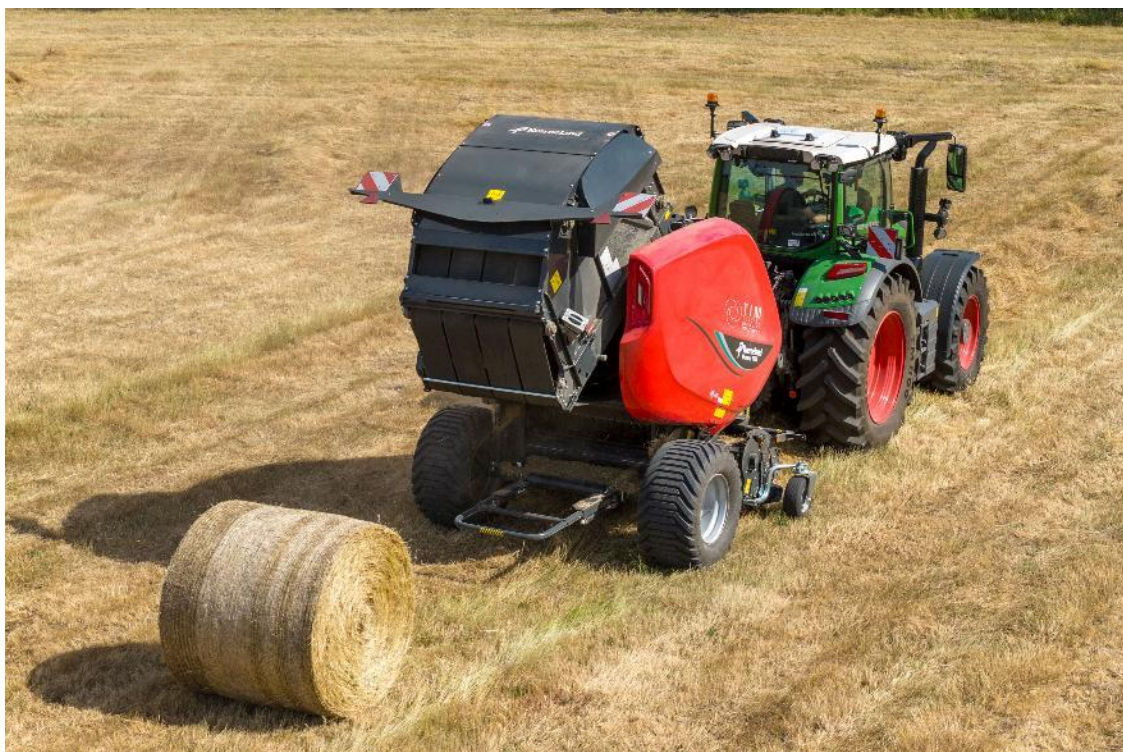
Kverneland Densus zaprojektowany do produkcji wysokiej jakości bel o średnicy do 1,85 m
