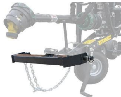
Przebudowana belka zaczepowa
