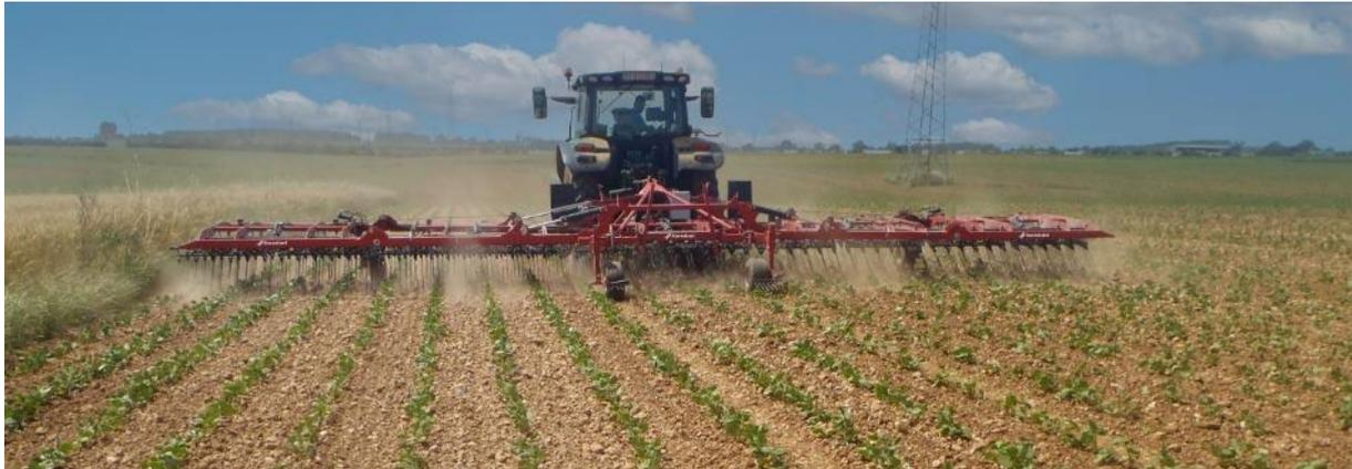
Un **telaio a 5 sezioni**, abbinato a ruote ben distribuite, garantisce un adattamento preciso al profilo del terreno e una profondità di lavoro uniforme. Con un peso a partire da 22 quintali, il modello da 12,2 m è sufficientemente leggero per l'utilizzo con trattori di medie dimensioni, riducendo al minimo la compattazione del terreno e garantendo al contempo un'adeguata deportanza.
