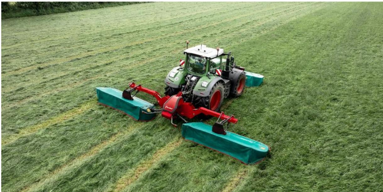
*La nuova falciatrice tripla Kverneland 5395, con una larghezza di lavoro di 9,5 m con l'innovativo sistema di sospensioni QuattroLink, offre un'impressionante capacità di falciatura.*
