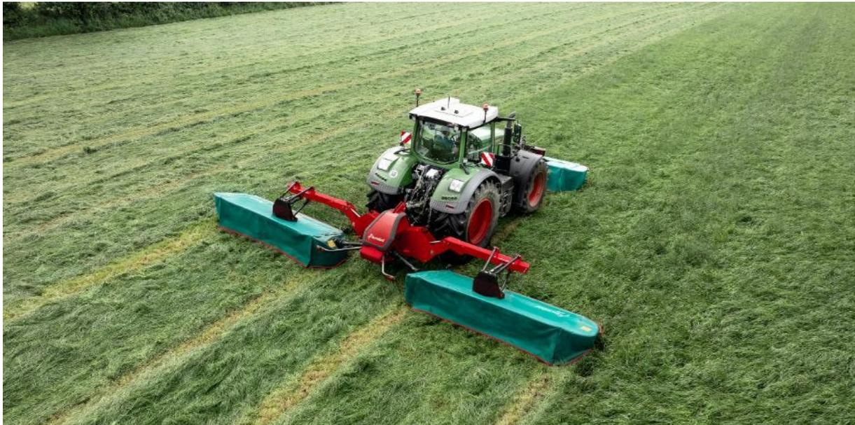
*La nueva segadora mariposa Kverneland 5395, con un ancho de trabajo de 9,5 m y el innovador sistema de suspensión QuattroLink, ofrece una capacidad de siega impresionante.*
