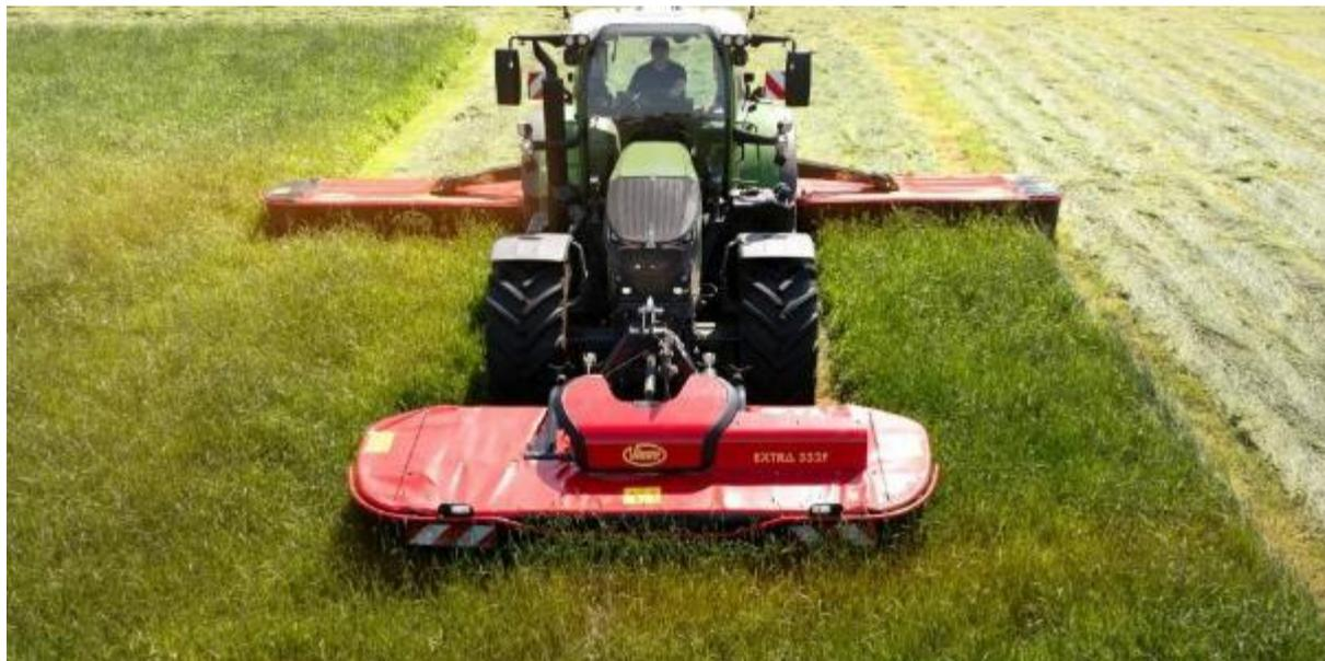
*La nueva segadora frontal Vicon 300F con un diseño compacto y una suspensión muy adaptable al terreno.*
