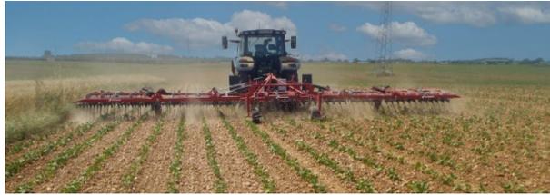
Ein **5-teiliger Rahmen** in Kombination mit gut verteilten Rädern sorgt für eine präzise Bodenanpassung und eine gleichmäßige Arbeitstiefe. Mit einem Gewicht von 2,2 Tonnen ist das 12,2 m lange Modell leicht genug für den Einsatz mit mittelgroßen Traktoren, wodurch die Bodenverdichtung minimiert und gleichzeitig ein ausreichender Anpressdruck gewährleistet wird.
