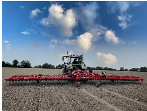
*Kverneland Arcadia Präzisionsstriegel mit 12,2 m Arbeitsbreite*
