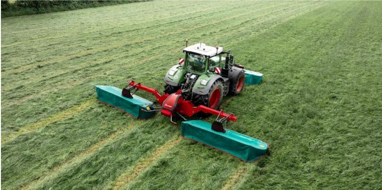
*La faucheuse sans conditionneur Kverneland 5395 offre une capacité de fauche élevée grâce à sa largeur de travail de 9,5 mètres et au concept de suspension QuattroLink.*
