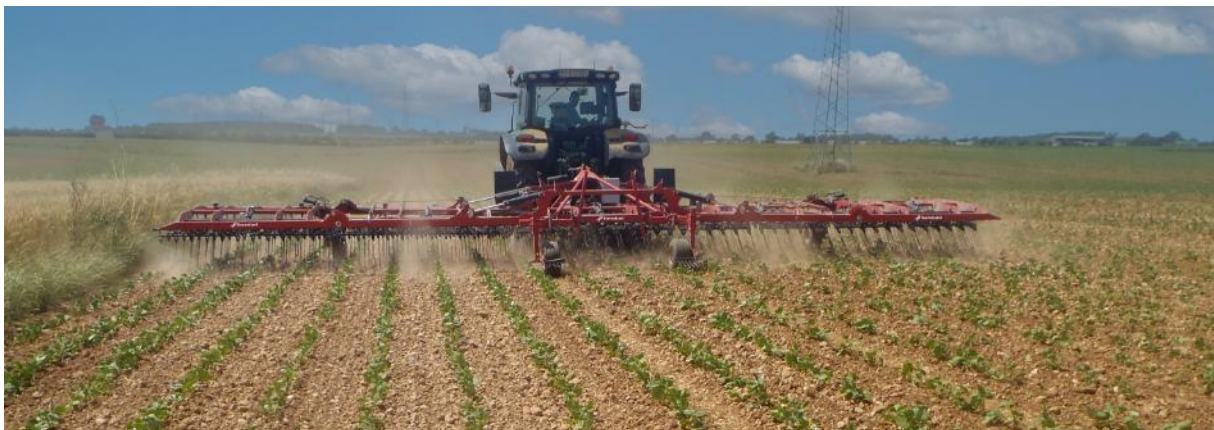
Het 12.2m brede model is voorzien van een 5-delig frame.
