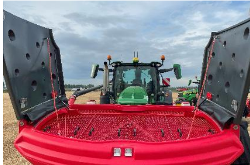
Einfacher Zugang zum Behälter – neues Siebdesign erhöht den Bedienkomfort
