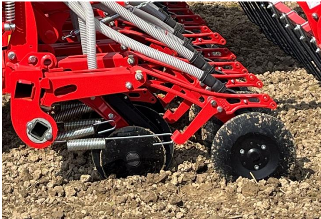
Nowa opcja: redlica Kverneland CX-II bez rolek dociskowych
