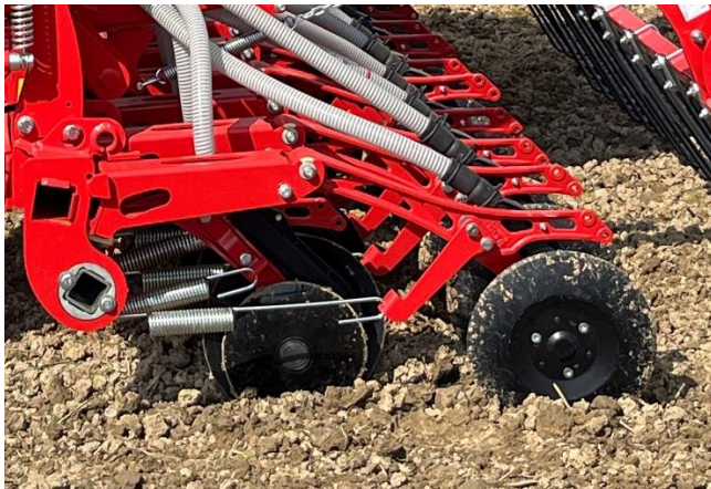
Nuova opzione: coltro Kverneland CX-II senza ruote pressa-seme.
